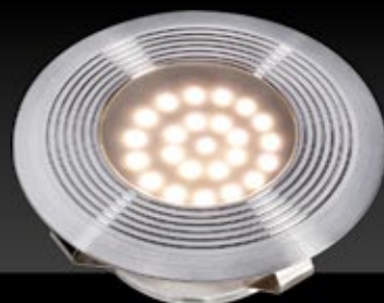
Mika R1 127D SMD LED 1,5W - A+ 2.700 K - 50 lm Stal nierdzewna 45 x 105 mm (WxS) Kabel 2 m
